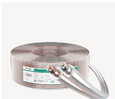
金银音响线 (100米、2*100芯-100无氧铜+100镀锡无氧铜) 型号: MT-YX2100
